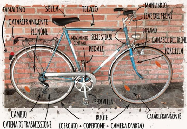
**RICORDA:** per il Codice della Strada (CdS) la bici deve essere munita di due copertoni, un freno per ciascuna ruota, un campanello, una luce bianca o gialla anteriore, una luce rossa posteriore, coppie di catarifrangenti (detti anche catadiottri) gialli sui pedali e su entrambi i lati delle ruote, e un catarifrangente rosso posteriore.
